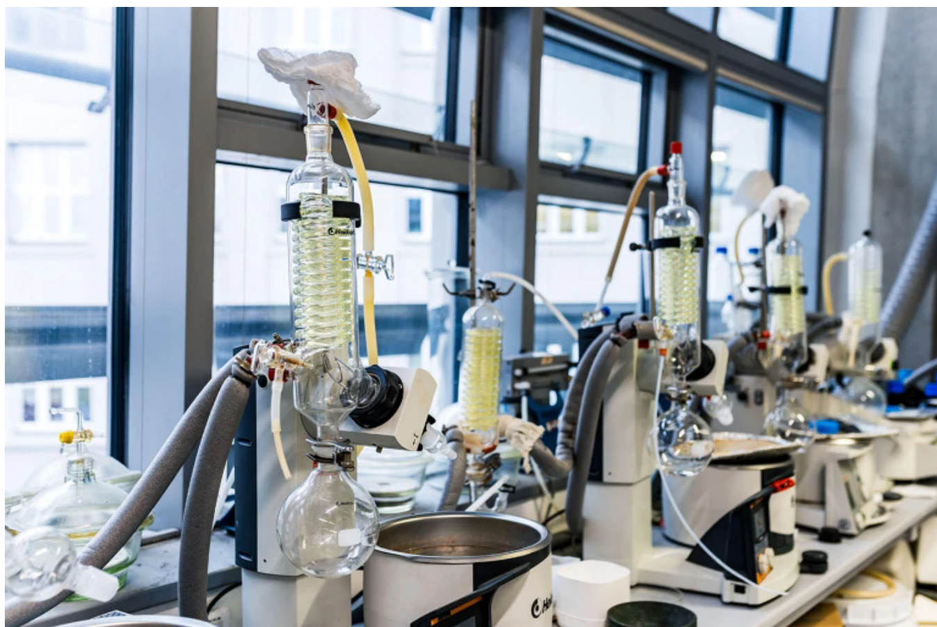
旋转蒸发仪用于从反应产物中脱除化学溶剂。图片来源：Forance/Alamy
