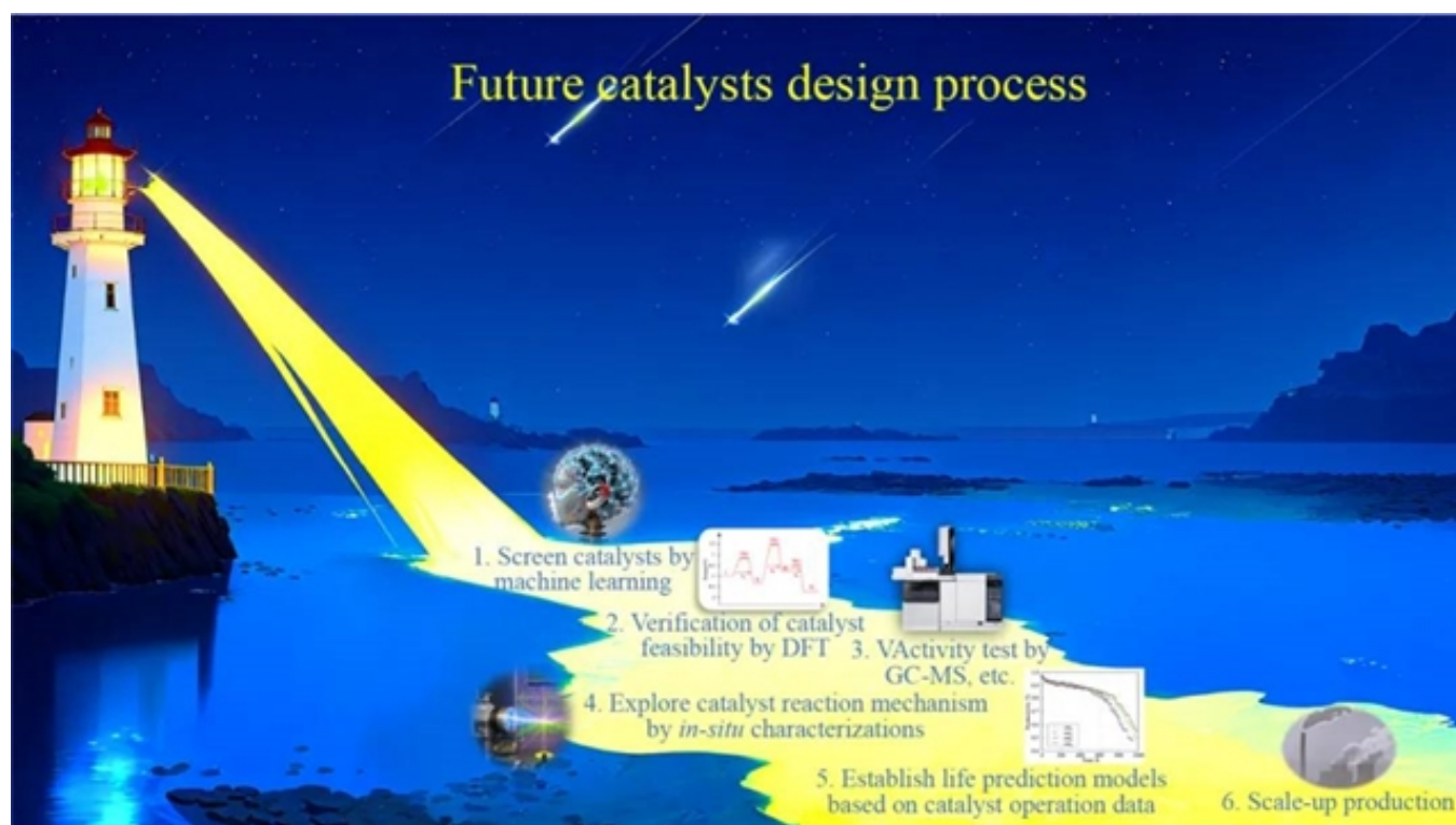
图4.未来DMO加氢催化剂设计流程示意图。该图是整篇综述核心思想的凝练与可视化呈现，完整勾勒出了未来DMO加氢催化剂从经验试错向理性设计转型的全流程。图示形成了原位表征+计算模拟解析反应机理-机器学习高通量筛选与性能预测-催化剂定向合成-性能验证-数据反馈优化模型的闭环研发逻辑，明确了未来催化剂设计需融合多尺度表征、理论计算、数据科学与实验验证，打破传统试错研发的桎梏。（来源：EngineeringJournals微信公众号）
