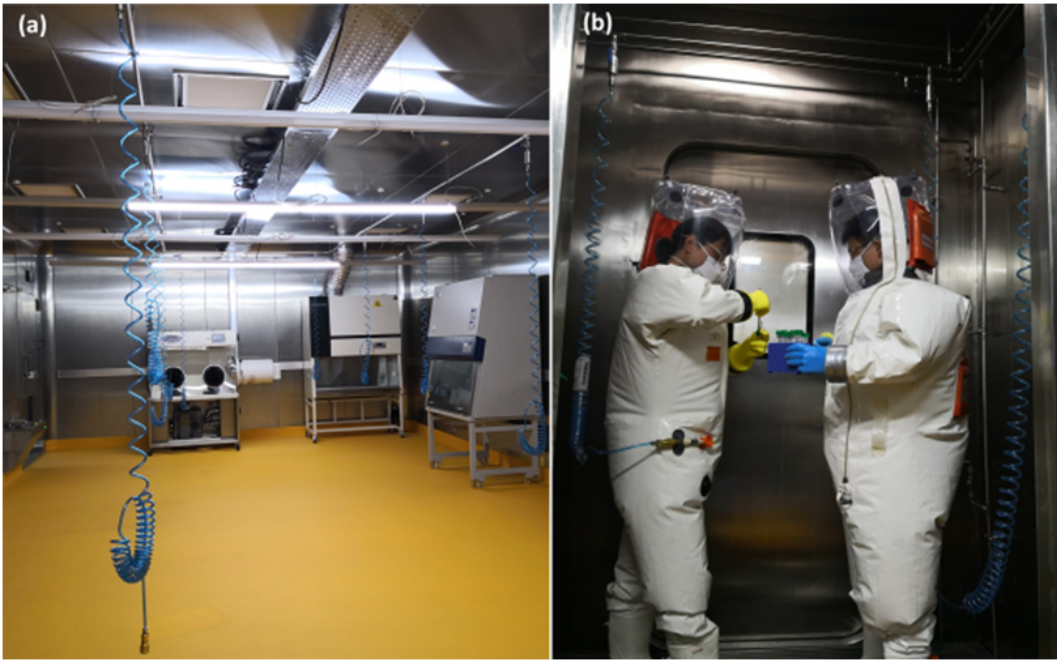
图：(a)用于人员培训的模拟实验室;(b)人员着正压防护服进行适应性训练
