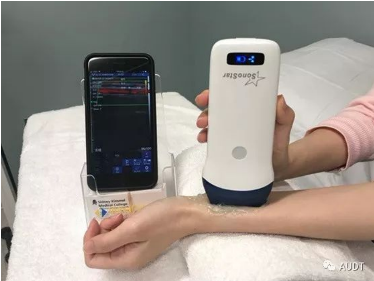
图12.掌上超声：与智能手机无线连接，实时传输显像。(Sonostar, 广州,中国)。
