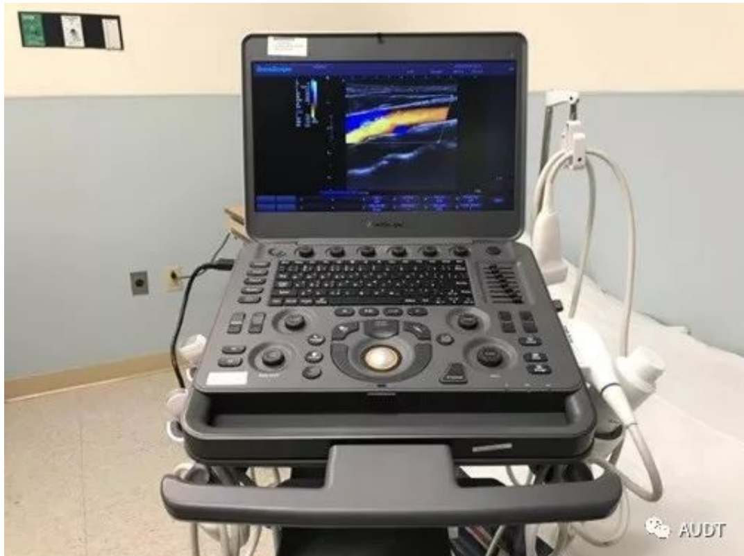
图11. 便携式超声：携带方便笔记本电脑式的超声仪器(开立公司,深圳,中国)。
