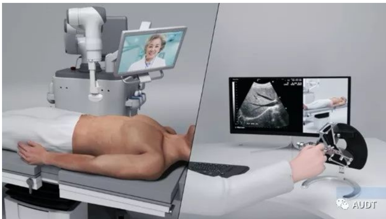
图14.轻型六轴机器人系统：机器人超声检查系统，探头(箭头)操作灵活、稳定。(Kuka, Augsburg, 德国)。
