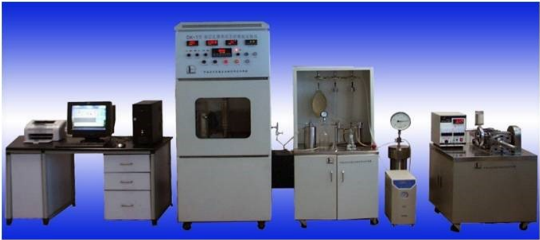
图1 地层孔隙热压生排烃模拟实验仪
