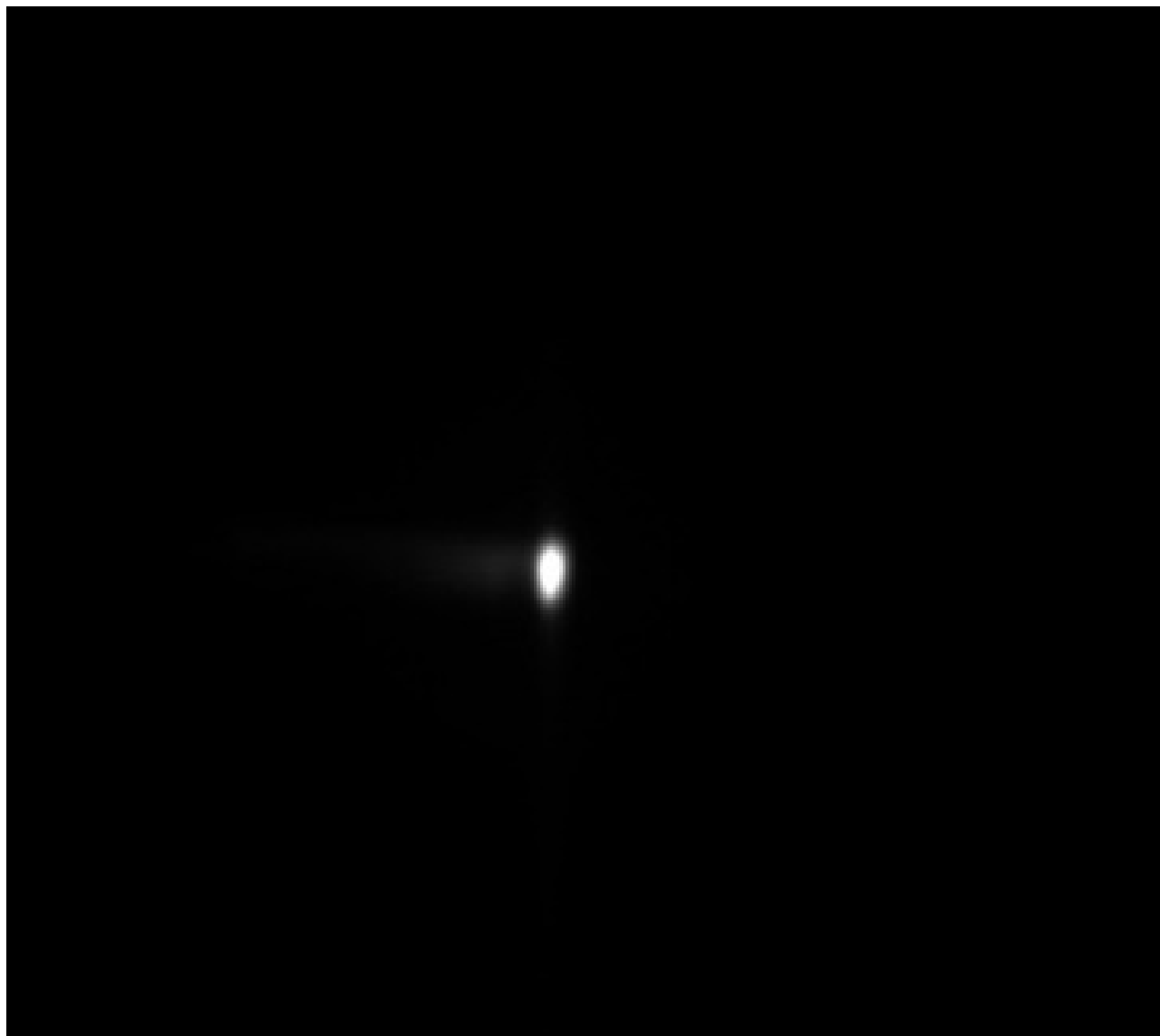
图4：Zn边附近多色光衍射聚焦光斑（小于20微米）
