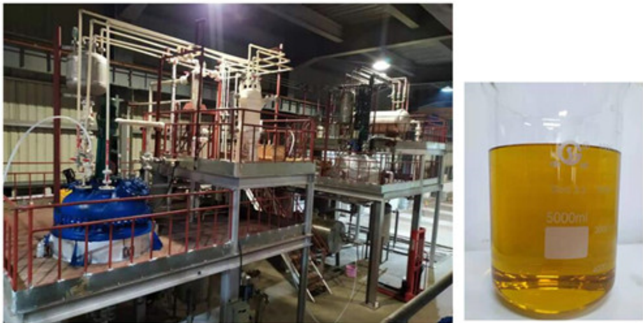
图2 实验室成功搭建液态聚碳硅烷中试装置，制备出公斤级产品
